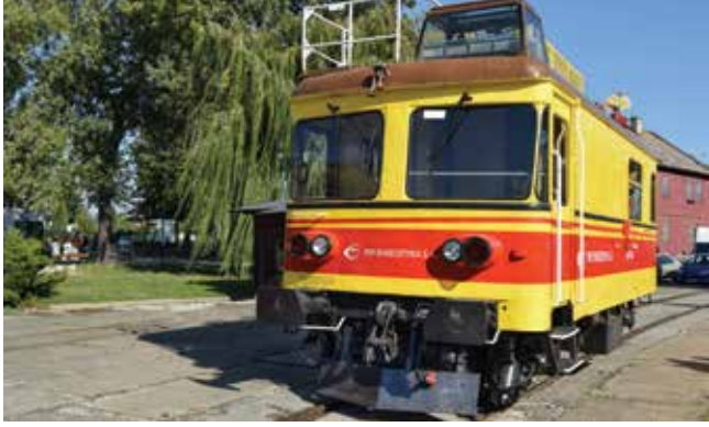
Wagon silnikowy do utrzymania sieci trakcyjnej SR71-04 – darowizna PKP Energetyka Fot. Ariel Ciechański
