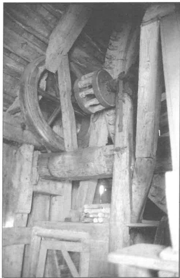
(fot. Inga Nowakowska) Wnętrze wiatraka w Zawadzie – przekładnia napędzająca młownik walcowy
